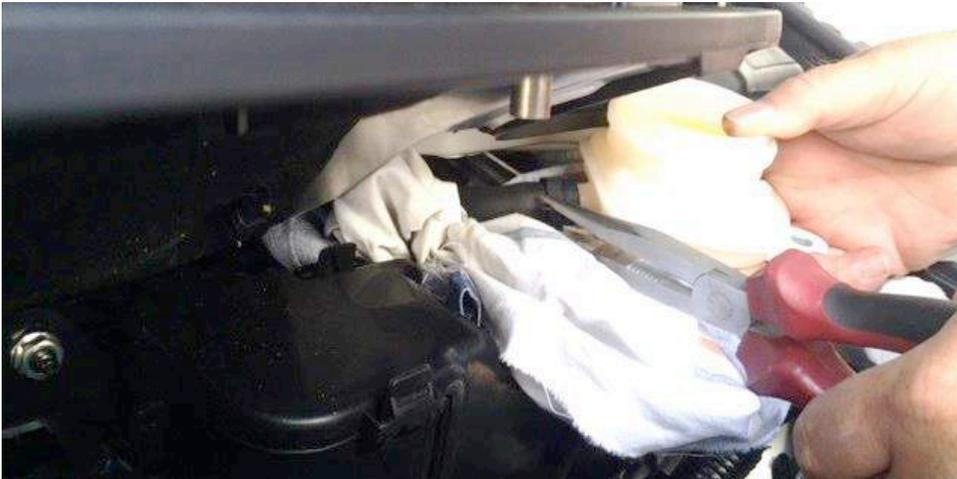
13. Drücken Sie die Spange mit die der Schlauch am Behälter fixiert wird mit Hilfe einer Zange zusammen und führen die Spange nach hinten weg. Entfernen Sie den Behälter.
