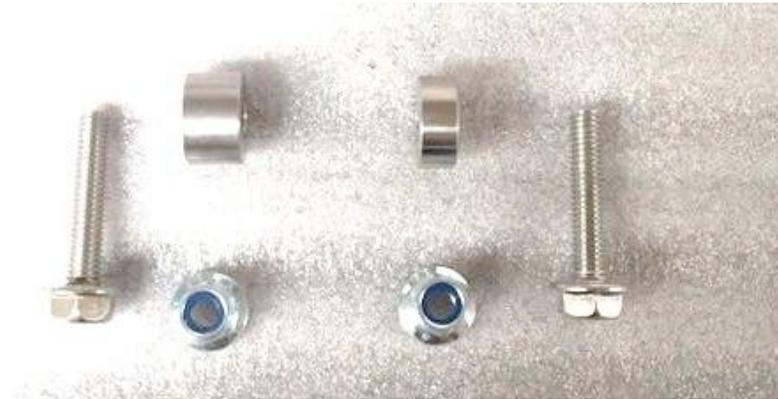
37. Identifizieren Sie die Abstandshalter. Der dickere Abstandshalter wird für den Bremsflüssigkeitsbehälter genutzt.
