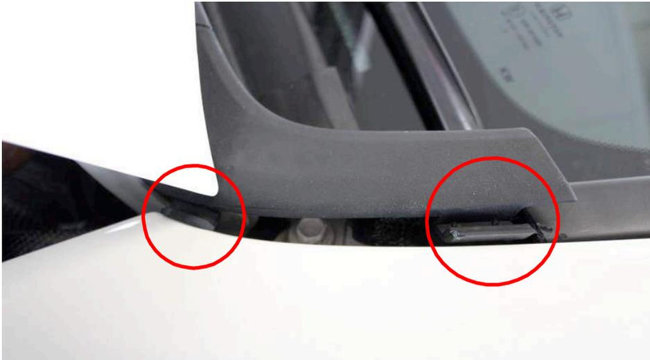
19. Lösen Sie die Haltetasen der Plastikabdeckung.
