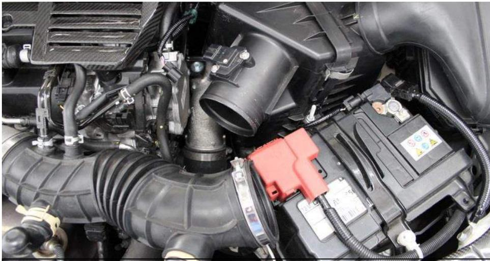
3. Lösen Sie das Gummrohr.
