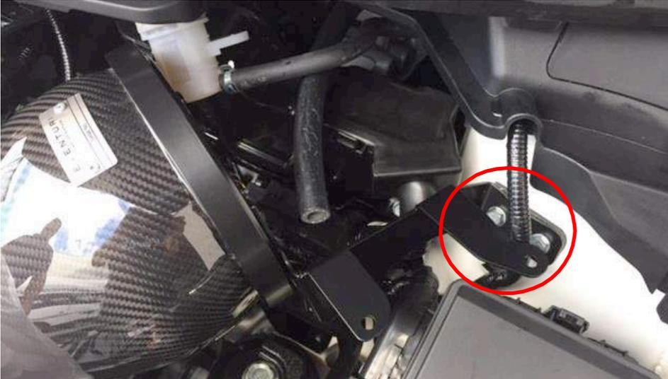
33. Positionieren Sie die Halterung am Luftfiltergehäuse an der Karosserie, befestigen Sie es NOCH NICHT. Behälter sind auf dem Bild zur demonstration entfernt.
