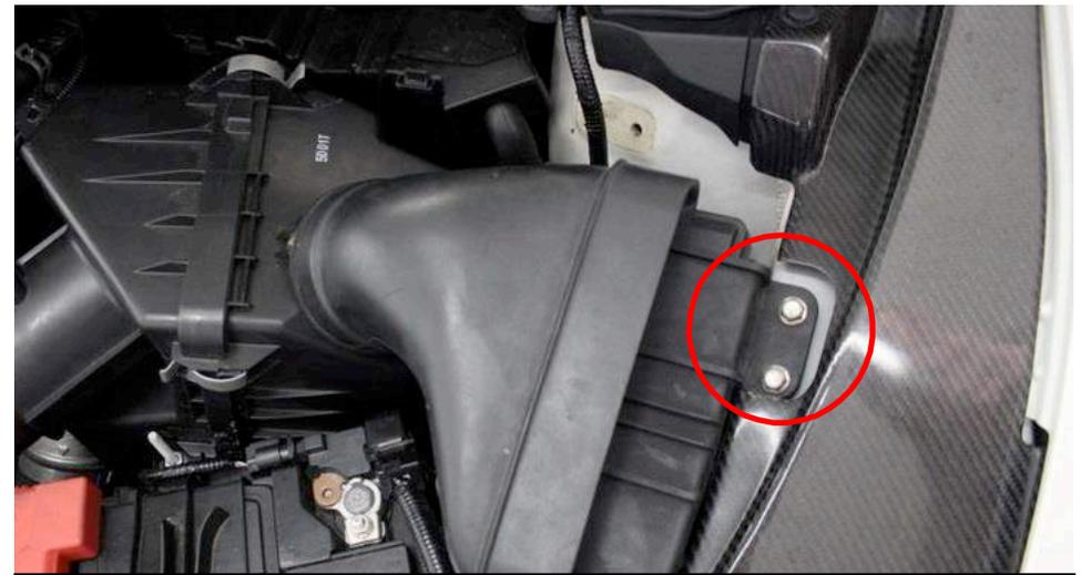
4. Entfernen Sie die beiden 10mm Schrauben.
