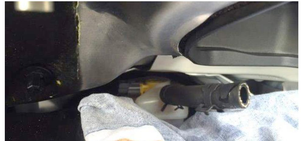
14. Drücken Sie die hintere Spange zusammen und entfernen Sie den Schlauch.
