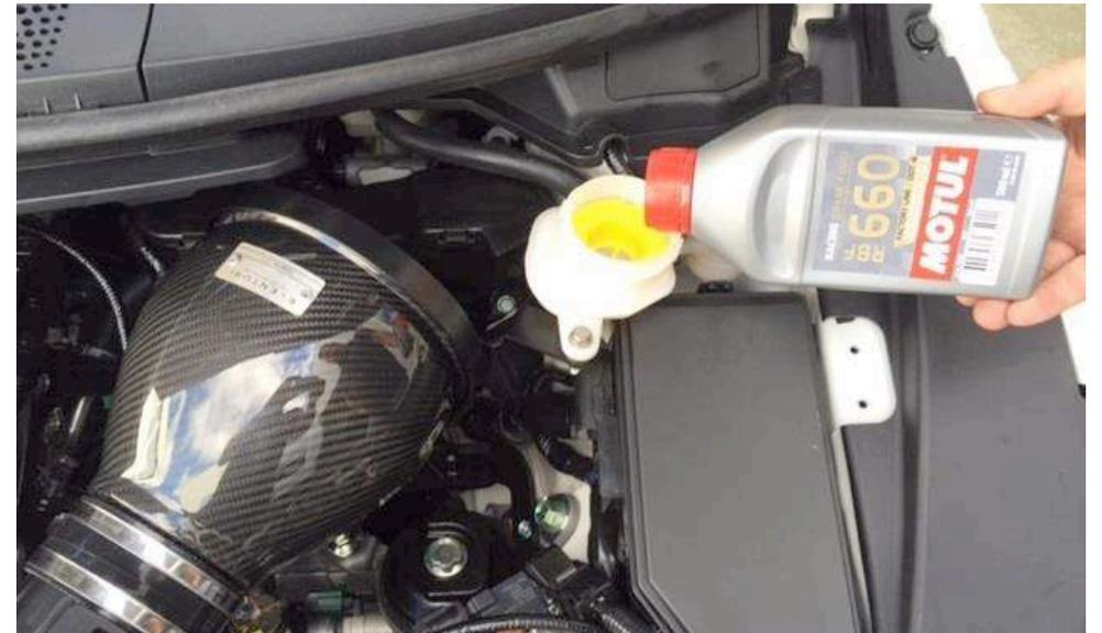
40. Füllen Sie DOT 4 Bremsflüssigkeit auf. Geben Sie der Flüssigkeit Zeit in den Schlauch abzulaufen, füllen Sie in Schritten nach bis die Flüssigkeit an der Markierung steht. Drehen Sie den Deckel des Behälter auf.
