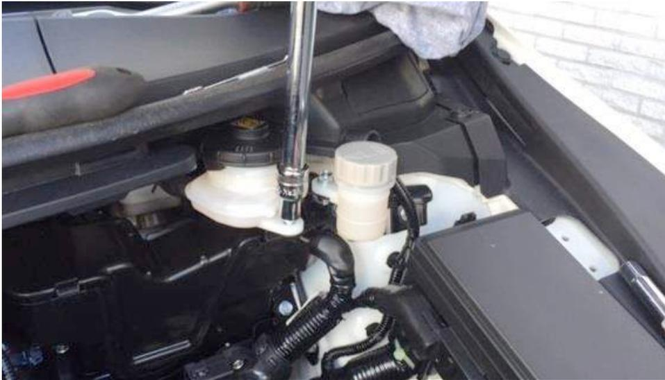
9. Entfernen Sie die Schrauben die die Behälter halten.
