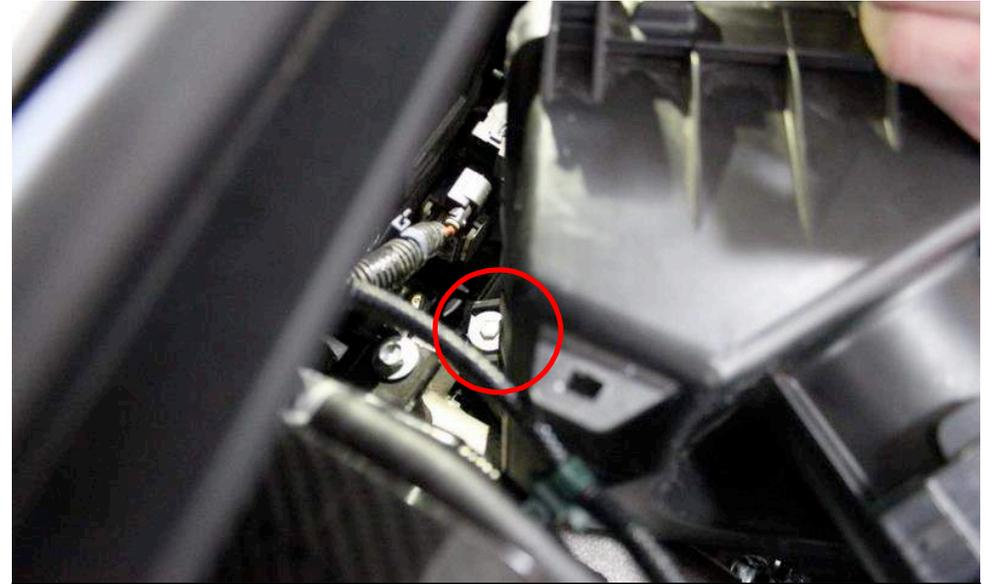
6. Entfernen Sie die zweite Schraube auf der Rückseite des Luftfilterkastens. Ziehen Sie den Luftfilterkasten heraus.
