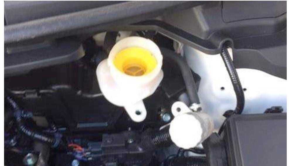
12. Leeren Sie den Bremsflüssigkeitbehälter mit einer Pumpe oder ähnliches. Halten Sie den Motorraum frei von Bremsflüssigkeit.
