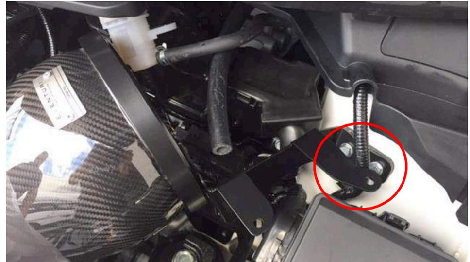
36. Befestigen Sie das Luftfiltergehäuse mit den beiliegenden M6 Schrauben.
