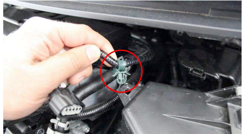
2. Entfernen Sie die Kabelführung vom Luftfilterkasten. Entfernen Sie den Anschluss vom Luftmassenmesser.
