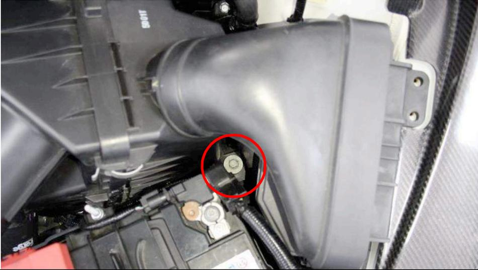
5. Der Luftfilterkasten wird von 2 10 mm Schrauben gehalten. Entfernen Sie die erste unterhalb der Batterie wie auf dem Foto markiert.
