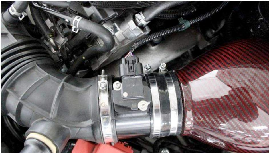
35. Ziehen Sie die Schelle fest und schließen den Luftmassenmesser an. Sollte das Kabel unter Spannung stehen, drehen Sie das Verbindungsrohr leicht nach unten.
