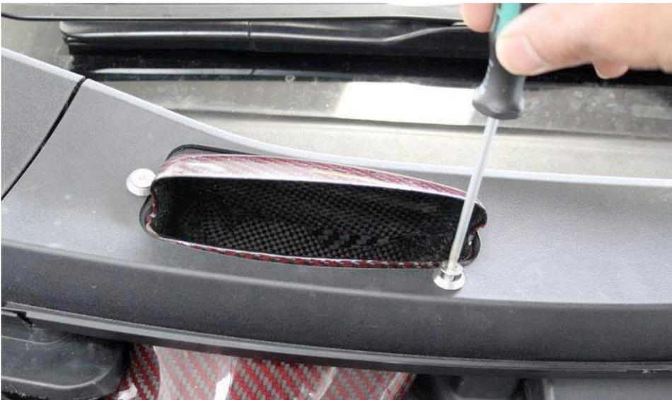
27. Montieren Sie die Luftführung, überdrehen Sie die Schrauben nicht.
