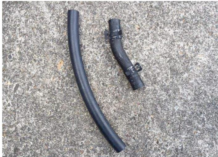
15. Übertragen Sie die Spangen auf den beiliegenden Schlauch.
