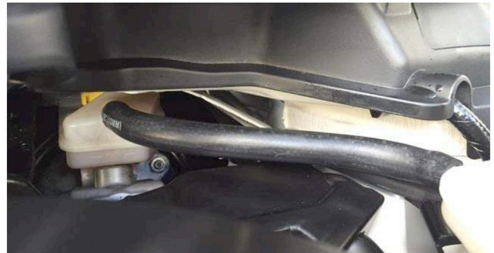
16. Schließen Sie den neuen Schlauch an beiden Behältern mit den originalen Klammern an. Nun wird zuerst die Luftführung verbaut, bevor die Umsetzung der beiden Behälter abgeschlossen wird.
