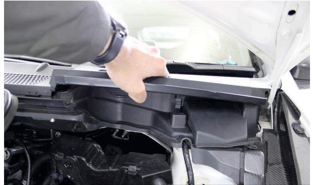
18. Ziehen Sie das Plastikabdeckung nach oben weg, um die Abdeckung zu lösen.
