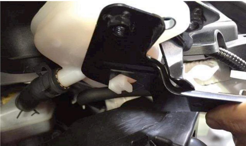
11. Lösen Sie den Bremsflüssigkeitbehälter vom Halter, er wird von unten gelöst.
