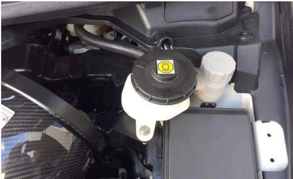
39. Nutzen Sie den dickeren Abstandshalter für den Bremsflüssigkeitsbehälter.
