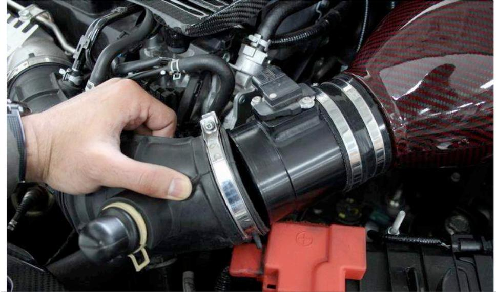
34. Führen Sie das Gummirohr auf das Verbindungsstück.
