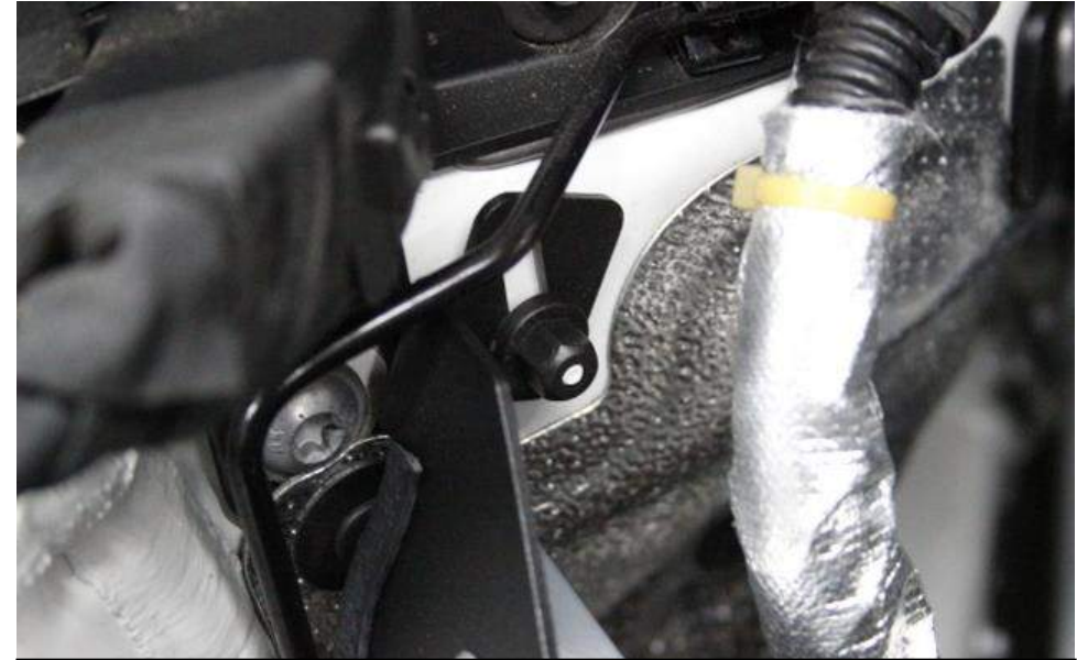
14. Hier das Schild nun mit der dafür mitgelieferten Kunststoffmutter fixieren. Dabei leichten Druck ausüben.
