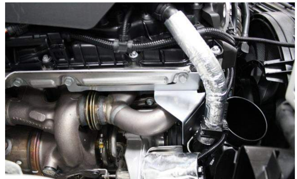
8. Nun werden die beiden Schrauben wieder an die alte Stelle angebracht und festgezogen. Das sekundäre Schild sollte nun so sitzen wie abgebildet
