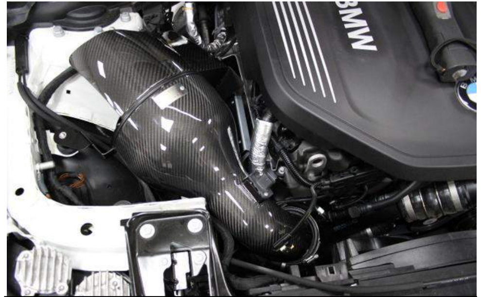
18. Jetzt das Carbon-Ansaugrohr vorsichtig in den Motorraum einsetzen und den Schlauch mit dem Silikon-Kuppler aus Schritt 9 verbinden.
