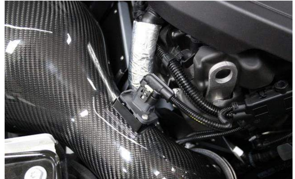
22. Den Luftmassenmesser wieder mit dem Kabel verbinden. Darauf achten, dass es auch korrekt einrastet. Die weiße Lasche nach unten drücken, um die Verriegelung zu aktivieren
