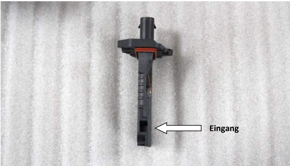
15. Jetzt den Luftmassenmesser aus der Airbox entfernen. Die Front des Luftmassenmessers hat ein Loch – siehe Abbildung. Diese MUSS in Richtung des Filters zeigen, welcher im nächsten Schritt montiert wird.
