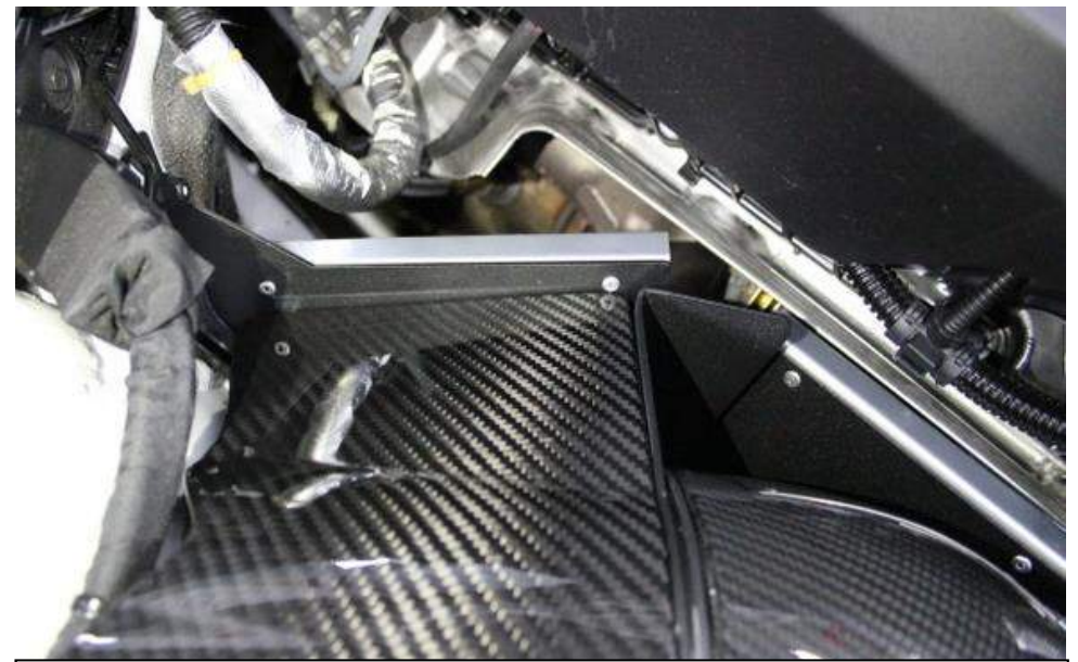
20. Das Carbon-Gehäuse so drehen, dass die Carbon-Abschirmung in einer Linie mit dem zuvor angebrachten Hitzeschild ist.
