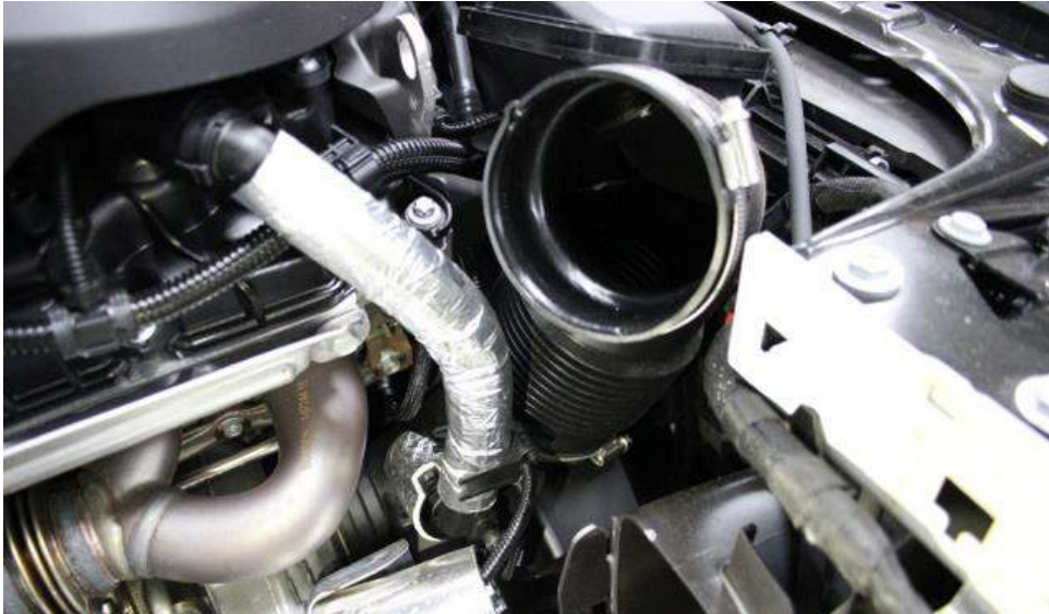
5. Das Einlassrohr mittels lösen der Schlauchklemme entfernen
