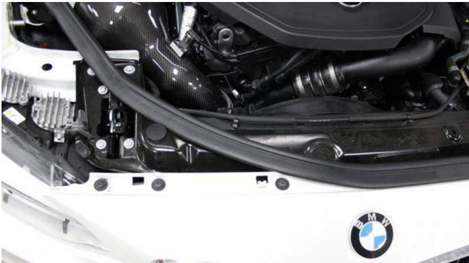
23. Jetzt die vordere Gummikante entfernen und die Torx-Schrauben lösen, um Zugang zur Rückseite der Nieren zu bekommen
