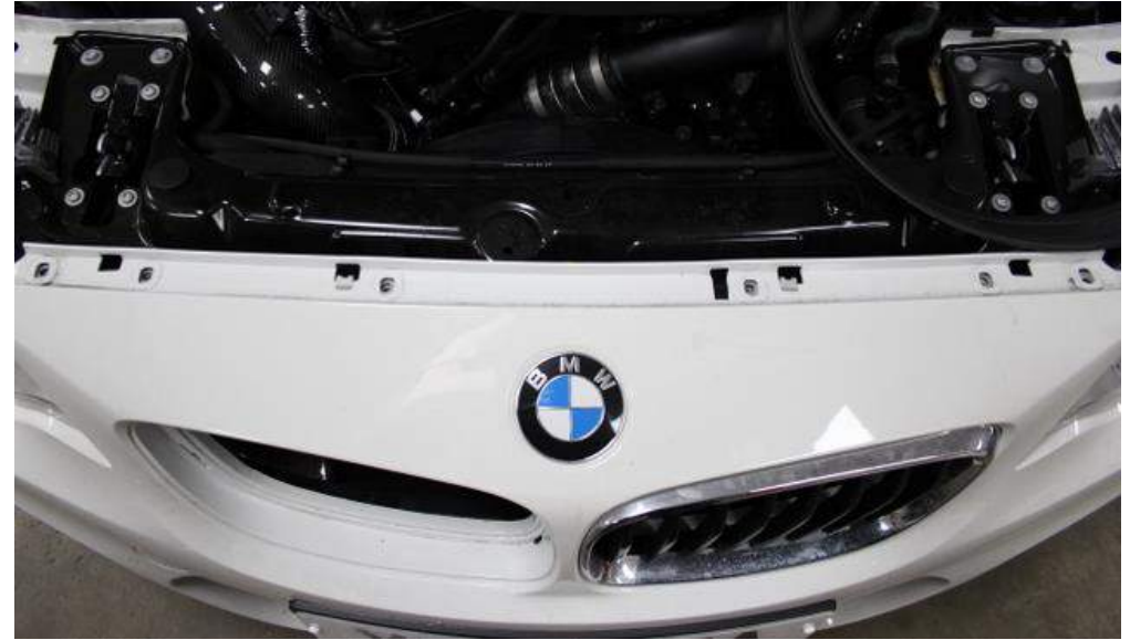
30. Jetzt die aus Schritt 23 gelösten Torx-Schrauben wieder festziehen und die Gummikante befestigen
