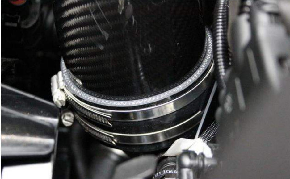
21. Das Carbon-Rohr nun vollständig über den Silikon-Kuppler schieben und die Schlauch-Schelle festziehen. Vorsicht: nicht zu festziehen
