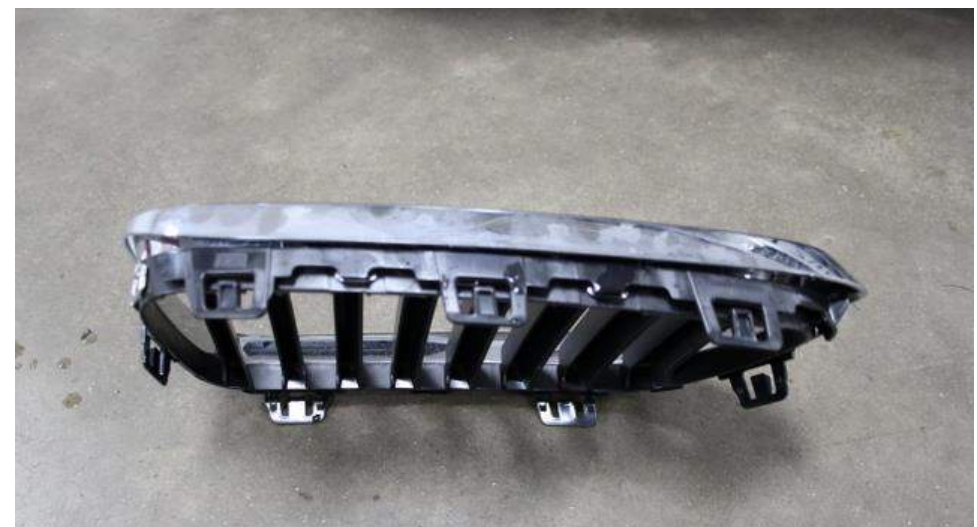
24. Um die linke Niere zu entfernen muss man die Laschen nach innen ziehen und gleichzeitig die gesamte Niere ziehen. Es befinden sich insgesamt sieben Laschen an der Rückseite der Niere, wie die Abbildung zeigt
