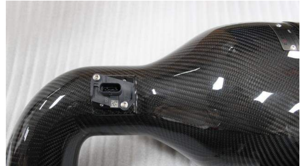
16. Den Luftmassenmesser in die Aufnahme in dem Carbon-Rohr einsetzen (für die Richtung vergleiche Schritt 15). Diesen nun mit den mitgelieferten M4 Torx-Schrauben befestigen
